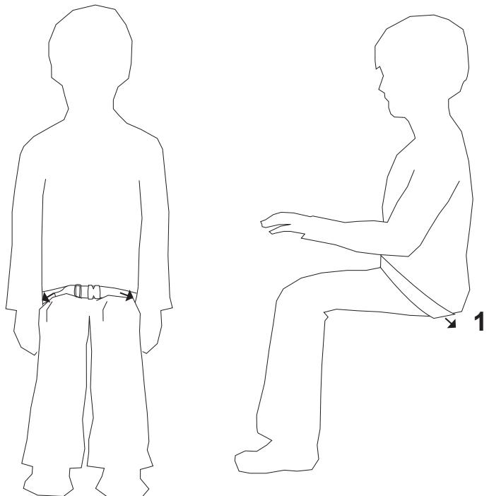
Gebruik de bevestigingen (A) op de stoel voor het monteren van de heupgordel. Als deze bevestigingen niet aanwezig zijn, gebruik dan de meegeleverde gordelbevestigingen voor het monteren van de heupgordel. Neem bij twijfel over de montage contact op met de dealer of met een medewerker van R82.
