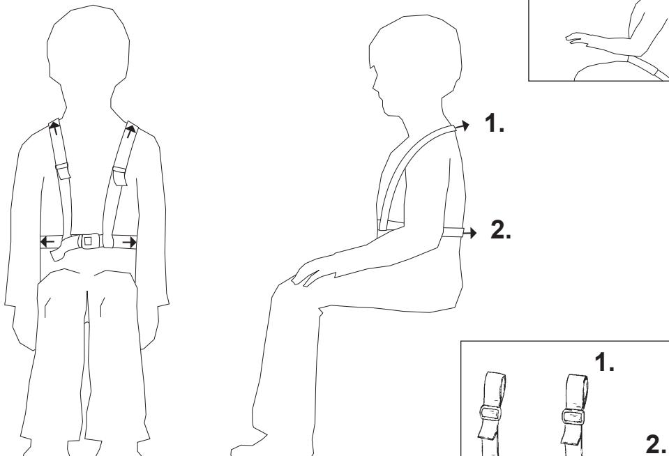
Gebruik de bevestigingen (A) en (B) op de stoel voor het monteren van de H-fixatie. Als deze bevestigingen niet aanwezig zijn, gebruik dan de meegeleverde klapgespen en gordelbevestigingen voor het monteren van de H-fixatie. Zie afbeeldingen (C) en (D). Neem bij twijfel over de montage contact op met de dealer of met een medewerker van R82.
