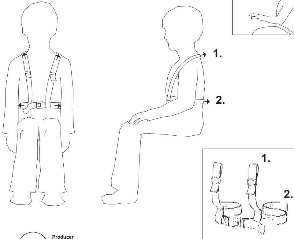
Utiliser les fixations (A) et (B) placées sur le siège pour monter le harnais en H. S'il n'a pas de fixations sur le siège, utiliser alors les boucles de fixation jointes au harnais en H pour le montage comme indiqué en schéma (C) et (D). En cas de doute lors du montage, contacter votre revendeur ou un thérapeute patenté.
