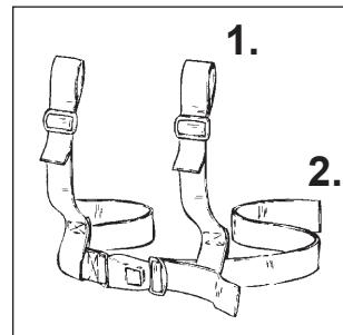
Använd beslagen (A) och (B) på stolen när du monterar H-selen. Om det inte finns monterade beslag bör du använda bifogade fixlock och bältesbeslag och montera H-selen som visas på bilderna (C) och (D). Kontakta din återförsäljare vid minsta tvekan om hur produkten ska monteras.
