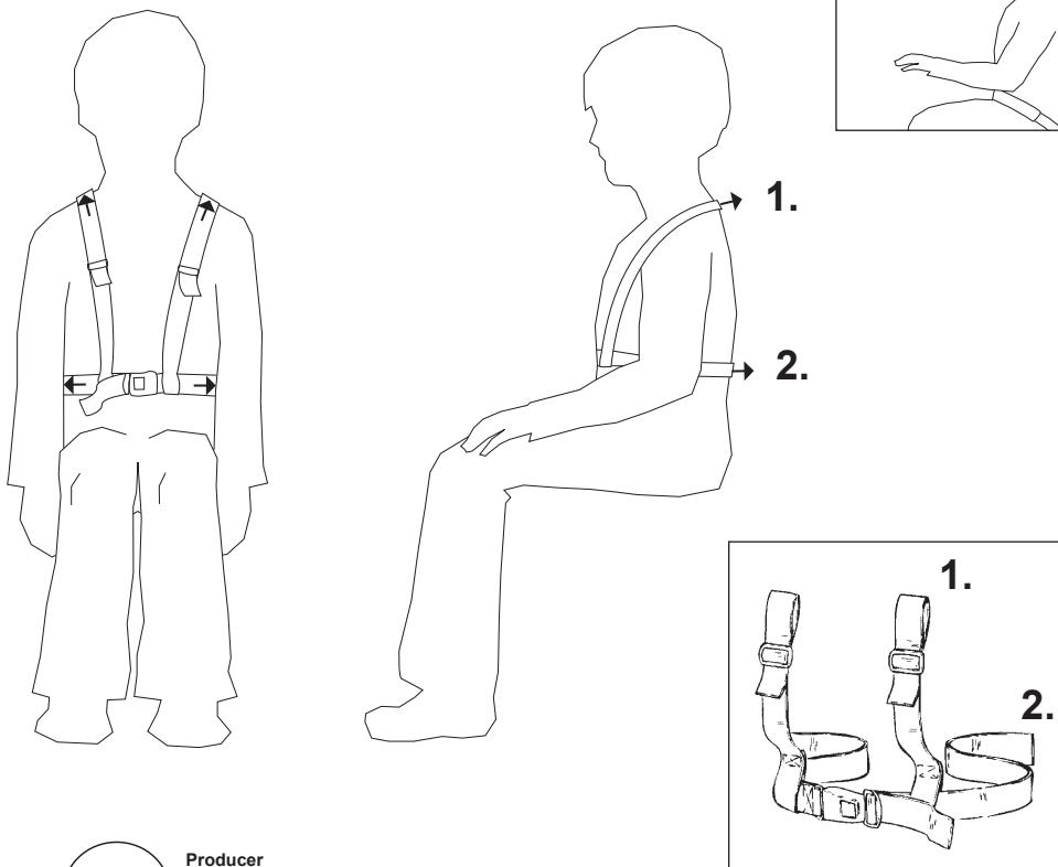
Bruk beslag (A og B) på stolen til å montere H-selen. Hvis det ikke er montert beslag, bruk da de vedlagte fix-locks og selebeslag (B) for å montere H-selen som vist på tegningene (C og D). Hvis det er tvil om monteringen, kontakt en lokal terapeut eller R82 forhandleren.
