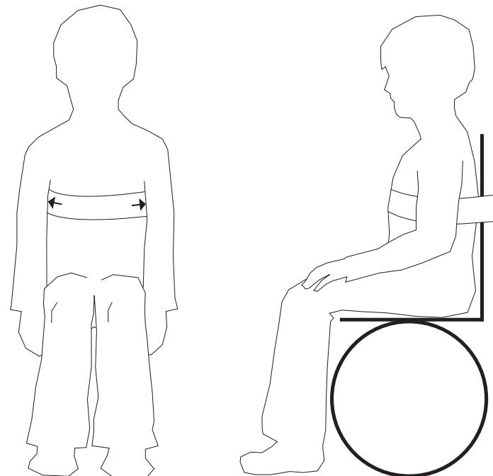
La ceinture se place autour de la poitrine de l'utilisateur et autour du dossier du siège. Utiliser le Velcro pour fermer la ceinture et verrouiller avec la boucle métallique.
