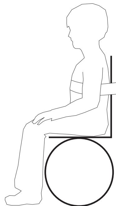
De band gaat rond de borst van het kind en rond de achterzijde van de stoel. Gebruik het klittenband voor het vastzetten van de gordel en vergrendel deze met de sluiting. Neem bij twijfel over de montage contact op met de dealer of met een medewerker van R82.
