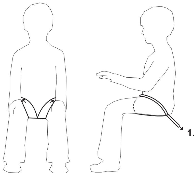
Använd beslagen (A) på stolen när du monterar abduktionssele. Om det inte finns monterade beslag bör du använda bifogade fixlock och bältesbeslag (B) och montera abduktionssele som visas på bilden. Kontakta din återförsäljare vid minsta tvekan om hur produkten ska monteras.
