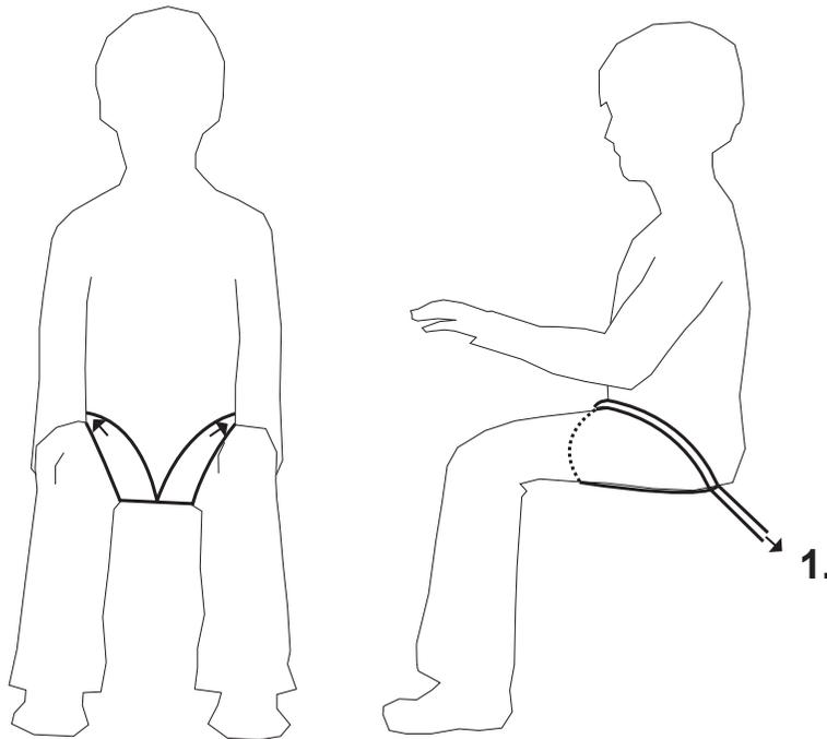
Gebruik de bevestigingen (A) op de stoel voor het monteren van de abductie-zitbroek. Als deze bevestigingen niet aanwezig zijn, gebruik dan de meegeleverde klagespen en gordelbevestigingen (B) voor het monteren van de abductie-zitbroek. (zie afbeelding). Neem bij twijfel over de montage contact op met de dealer of met een medewerker van R82.
